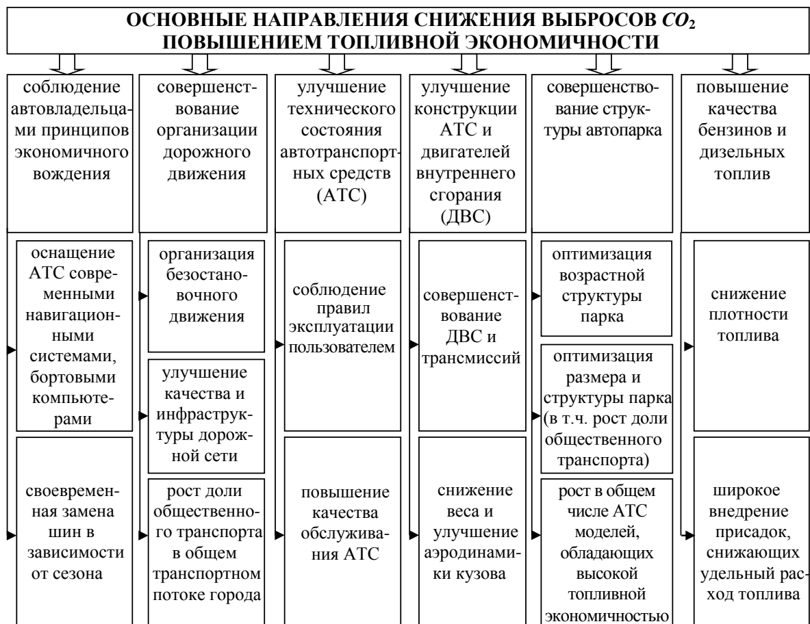
Рис. 7. Основные направления снижения выбросов CO 2 повышением топливной экономичности автомобилей с бензиновыми и дизельными двигателями
