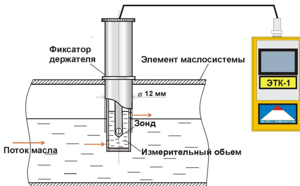
Рис. 9. Вариант схемы сопряжения датчика с маслосистемой. Арматура датчика представляет собой коаксиальные детали, смещением которых друг относительно друга осуществлялось регулирование скорости движения масла в измерительном объеме.
