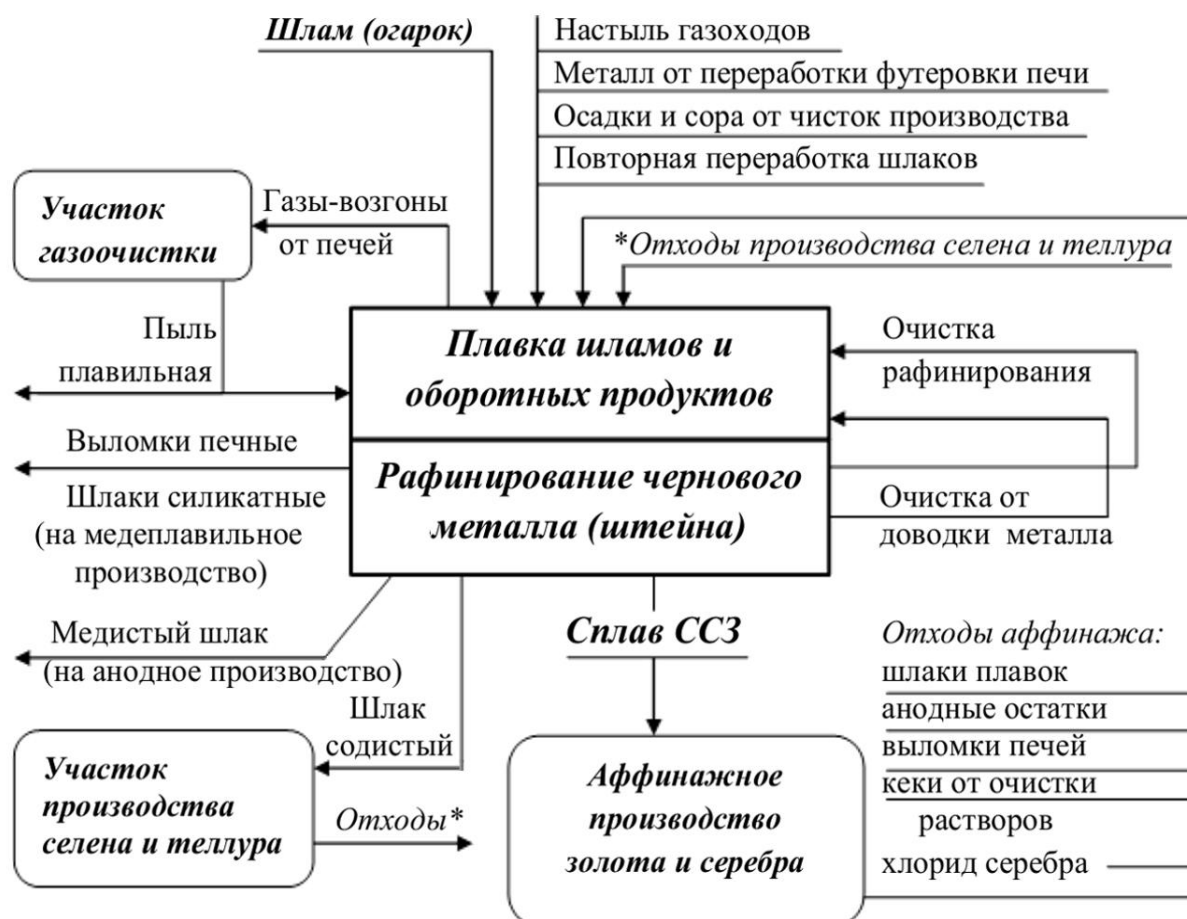
Рисунок 1 – Общая схема образования и движения отходов и оборотных продуктов при плавке на сплав серебрено-золотой
