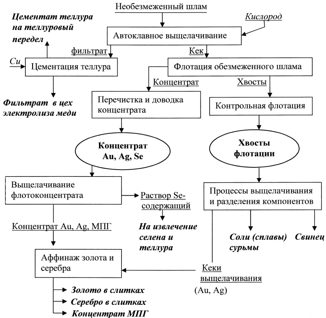
Рисунок 21 – Разработанная технологическая схема комплексной переработки медьэлектролитных шламов
