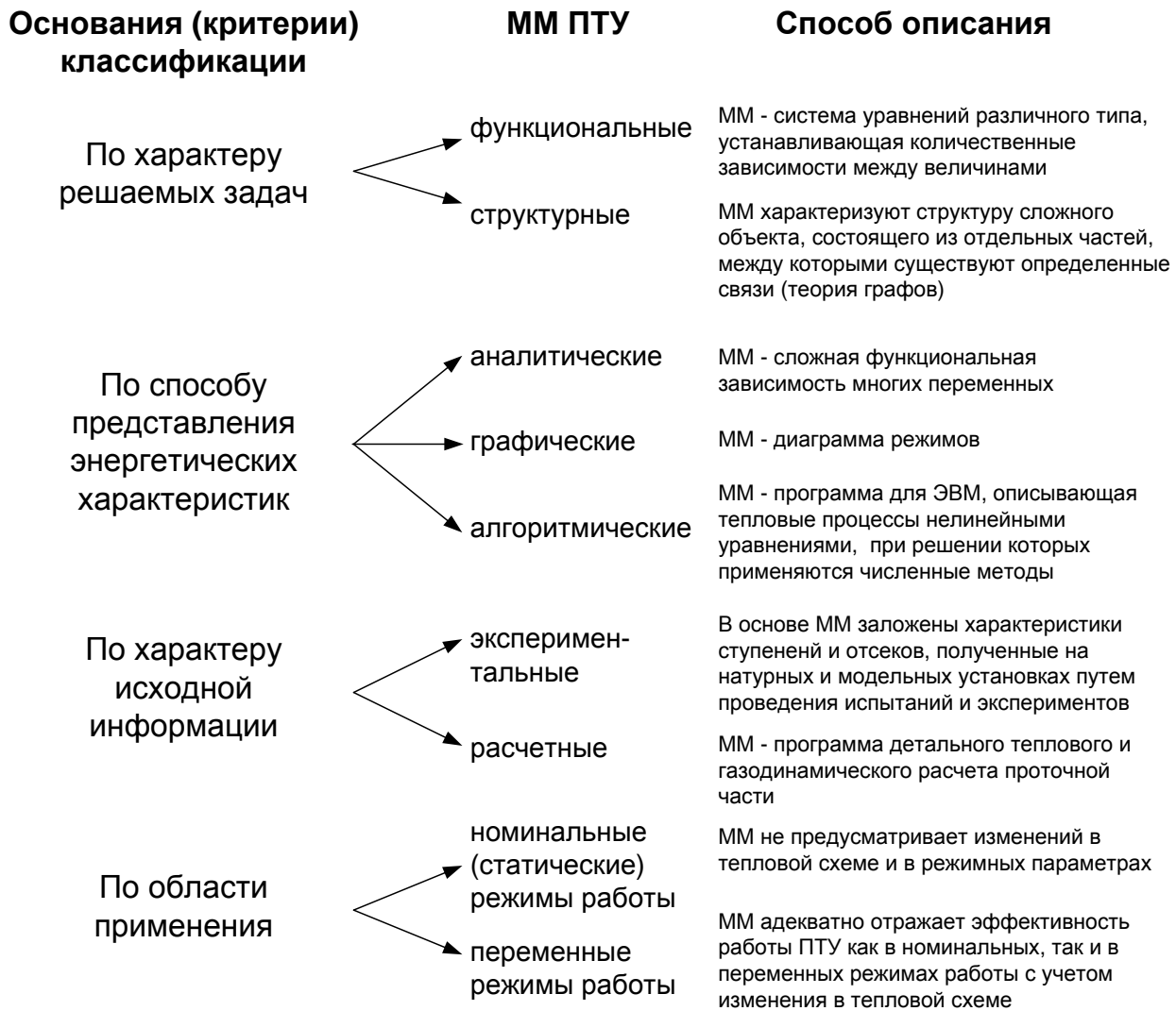
Рисунок 1 – Классификация математических моделей (ММ) паротурбинных установок (ПТУ)
