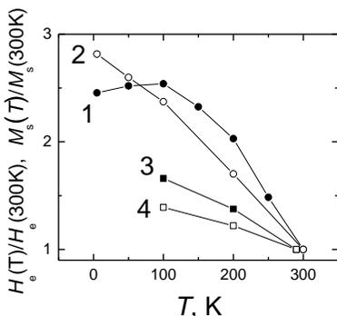
Рис. 8 – Температурные зависимости приведённых величин поля обменного смещения (1,3) и спонтанной намагниченности (2,4) для плёнок  $\text{Fe}_{20}\text{Ni}_{80}/\text{Tb}_{29}\text{Co}_{71}$  (1,2) и  $\text{Co}/\text{Tb}_{27}\text{Co}_{73}$  (3,4).
