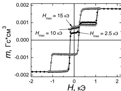
Рис. 7 – Полные петли гистерезиса, измеренные вдоль ОЛН на образце Co/Tb<sub>27</sub>Co<sub>73</sub> при T = 300 К в полях разной амплитуды H<sub>max</sub>.
