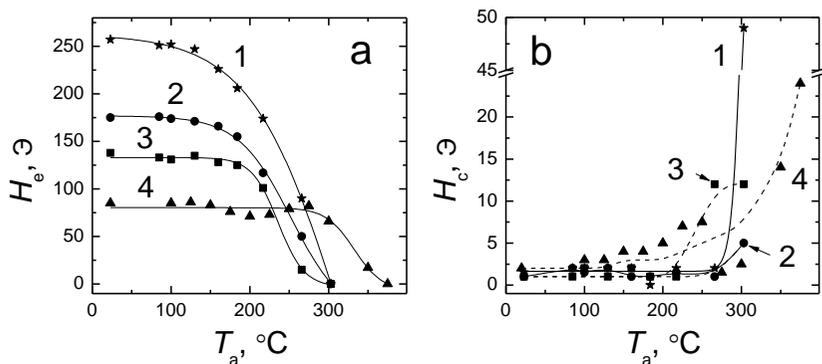
Рис. 11 – Зависимости поля обменного смещения  $H_e$  (a) и коэрцитивной силы  $H_c$  (b) слоя пермаллоя от температуры ступенчатого отжига, полученные на пленках следующих типов:
