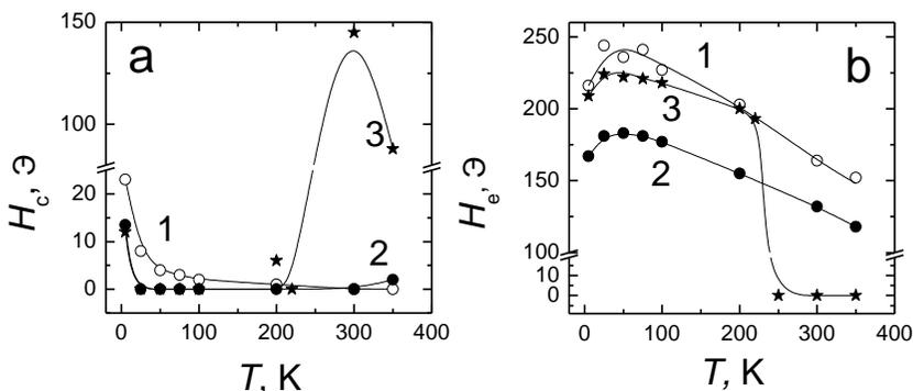
Рис. 10 – Температурные зависимости коэрцитивной силы (а) и поля магнитного смещения (б) магнитомягкого слоя в плёнках  $\text{Tb}_{29}\text{Co}_{71}/\text{Co}(L_{\text{Co}})/\text{Fe}_{20}\text{Ni}_{80}$  с различной толщиной прослойки Co: 1 – 0,3; 2 – 0,8; 3 – 1,5 нм.
