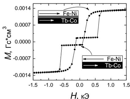
Рис. 6 – Полная петля гистерезиса, измеренная на образце Fe<sub>20</sub>Ni<sub>80</sub>/Tb<sub>28</sub>Co<sub>72</sub> вдоль ОЛН при T = 300 К. Вставки показывают направления намагниченности в слоях.
