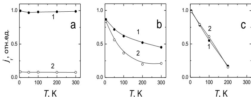
Рис. 5 – Температурные зависимости приведенной остаточной намагниченности пленок Tb<sub>17</sub>Co<sub>73</sub> (a), Tb<sub>29</sub>Co<sub>71</sub> (b), Tb<sub>38</sub>Co<sub>62</sub> (c). Значения  $j_r$  определены после намагничивания в поле напряжённостью 70 кЭ вдоль (кривые 1) и перпендикулярно (кривые 2) оси приложения технологического поля.
