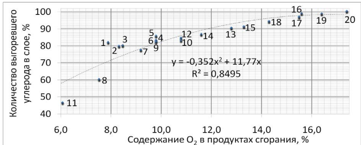
Рисунок 3 – Зависимость относительного количества выгоревшего в слое под горном углерода от содержания O 2 в продуктах сгорания
