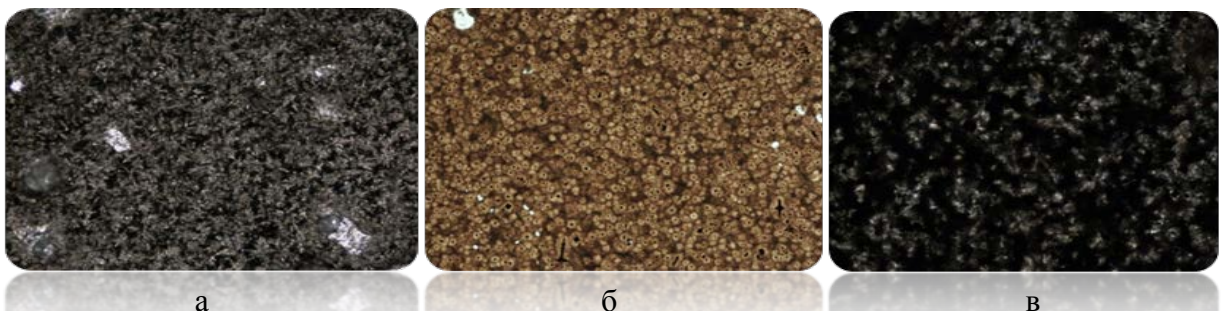
Рисунок 2 – Петрографический анализ горных пород Урала: а – габбро, \times 200 ; б – горнблендита, \times 200 ; в – базальтоидной группы, \times 200
