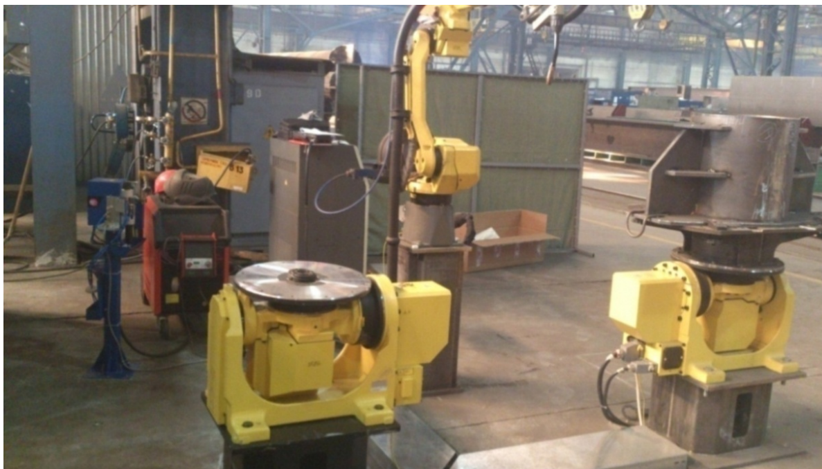
Рисунок 6 – Внешний вид роботизированной установки для сварки муфт
