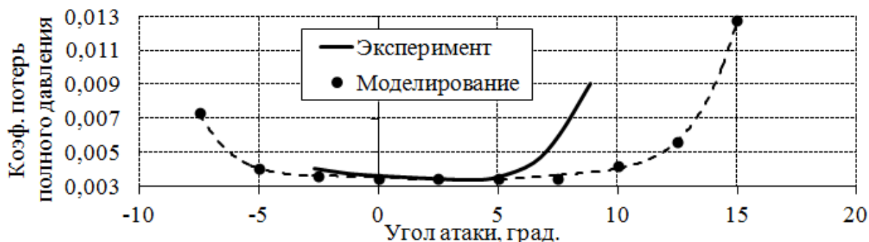
Рисунок 2 – Зависимость изменения коэффициента потерь полного давления от угла атаки по результатам натурного и численного (SST GTM, 1 500 000 ячеек) экспериментов продувки решетки из профилей 10А40/15П45 при числе Маха 0,6
