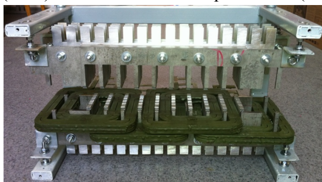
Рисунок 12 – Магнитопроводы МГД-насоса установленные на раму
