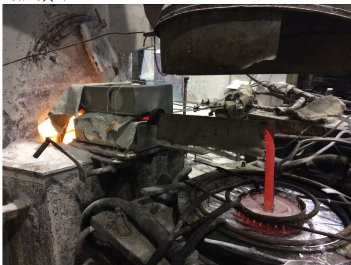
Рисунок 9 – Отливка магниевого сплава при помощи опытно-промышленного образца МГД-насоса
