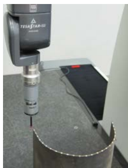
Рис. 28. Заготовка после предварительной формовки: схема измерения координат заготовки на КИМ.
