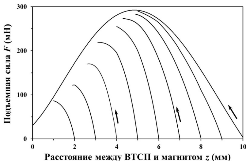
Рис. 16. Рассчитанные зависимости подъемной силы от расстояния между образцом и магнитом для разных путей намагничивания. Стрелки показывают, как изменяется сила при движении магнита из начального положения.
