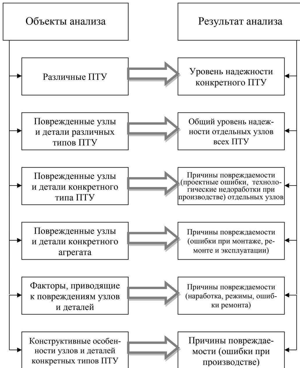
Рис. 2. Структура анализа показателей надежности оборудования ПТУ
