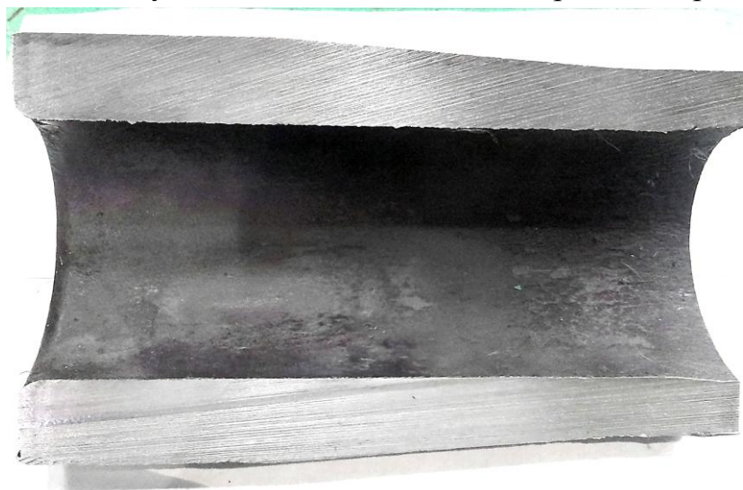
Рисунок 13 – Высаженный конец бурильной трубы ПН 73х9 в соответствии с ГОСТ Р 50278-92
