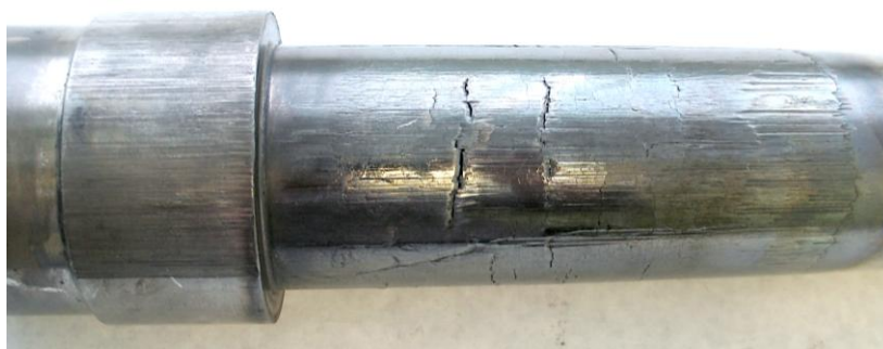
Рисунок 12 – Сетка разгара и поперечная трещина на поверхности пуансона
