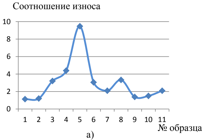
Рисунок 14 – Износостойкость оксидного покрытия образцов (а), снимок следа износа на образце, увеличение x160 (б)
