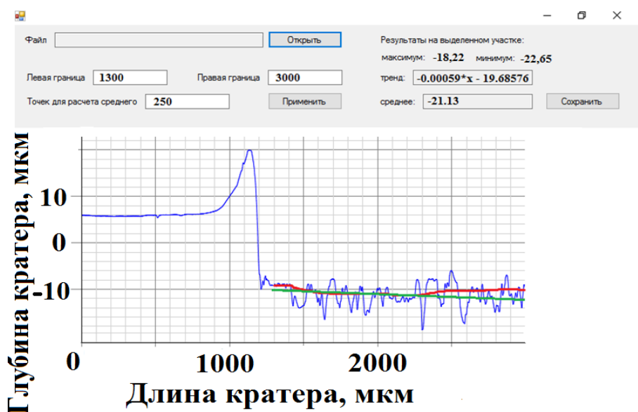
Рисунок 2 - Половина профиля кратера ионного травления с результатами математической обработки участка дна кратера
