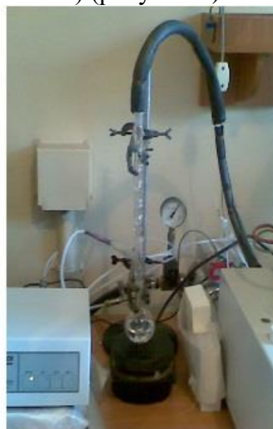
Рисунок 4 – Схема и внешний вид экспериментальной установки насыщения аргона парами толуола в системе ТА-МС
