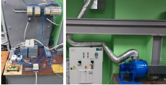
Рисунок 3 - Испытания АД в составе вентилятора ВЦ 4-75
