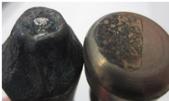
Рисунок 22 – Изношенный дугогасительный контакт при 100 В после 100 операций (слева) и дугогасительный контакт при 20 В после 160 операций (справа)
