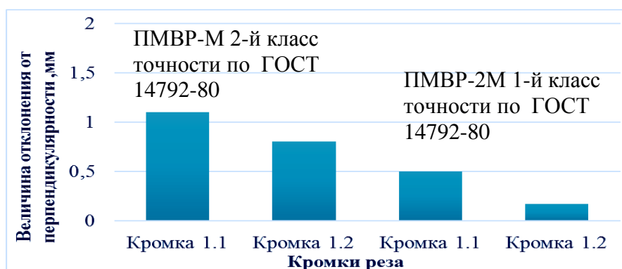
Рисунок 11 – Величина отклонения от перпендикулярности кромок реза
