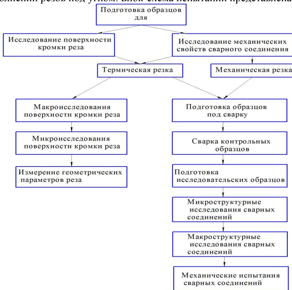
Рисунок 8 – Блок-схема подготовки образцов для испытаний
