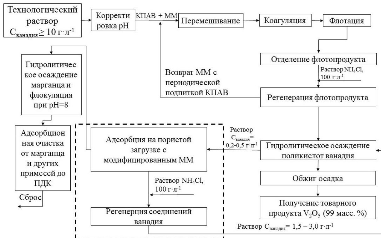
Рисунок 16 – Принципиальная схема извлечения соединений ванадия из технологических растворов
