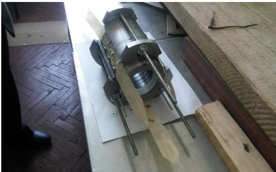
Рис. 17 - Вариант индуктора с тремя симметричными пазами, каждый под свою фазу
