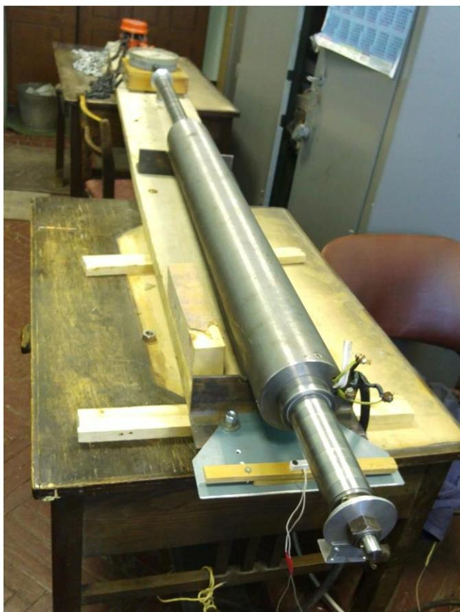
Рисунок 13 - Модуль ЦЛВД в сборе на испытательном стенде для снятия статических характеристик
