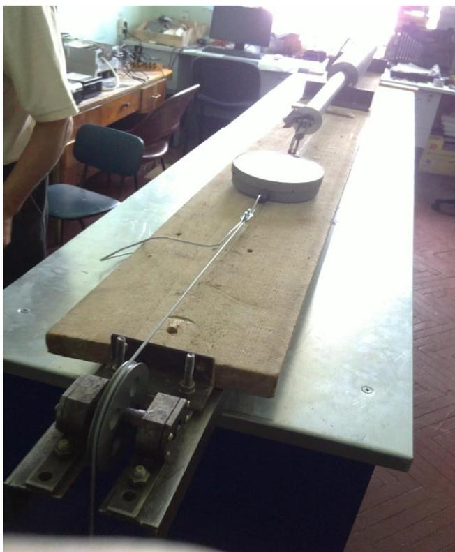
Максимальное тяговое усилие, полученное при динамических испытаниях, составило 3,0 кН при токе 30А, это усилие равно электромагнитному тяговому усилию за вычетом сил трения, согласно (7).
