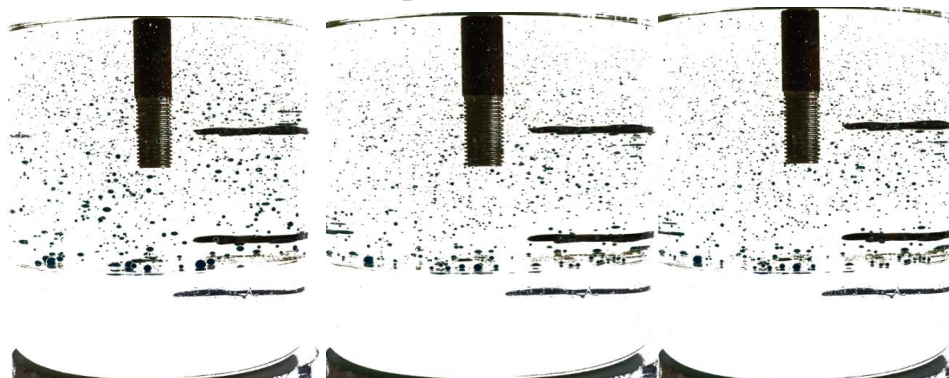
Рисунок 7 – Пример обработанных снимков из серии, использовавшихся при анализе процесса оседания капель
