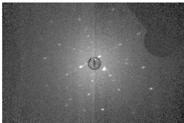
Рисунок 2 – Лауэграмма продольного сечения кристалла \text{EuBaCo}_{1.90}\text{O}_{6-\delta}
