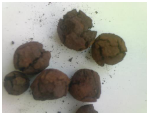
Рис. 10 – Гранулы в конечной стадии обжига
