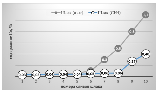
Рисунок 3 - Кобальт и никель в шлаке после обеднения с азотом и \text{CH}_4
