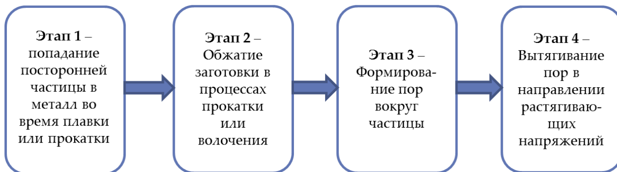
Рисунок 4 – Алгоритм образования раковины вокруг частицы включения
