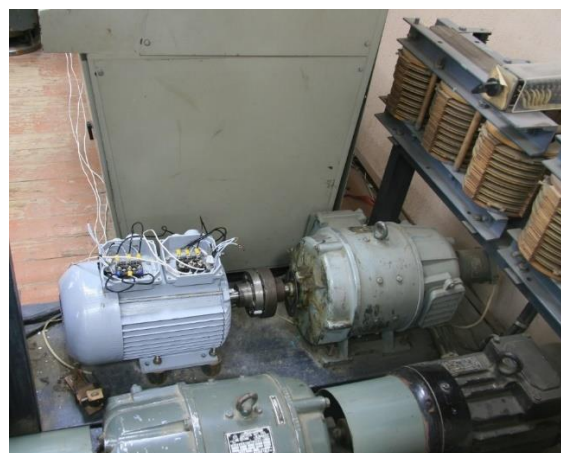
Рисунок 22 – Установленный в машинный ряд для испытаний АДКО
