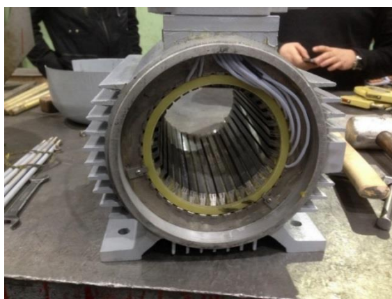
Рисунок 19 – Впрессованный в станину статор АДКО
