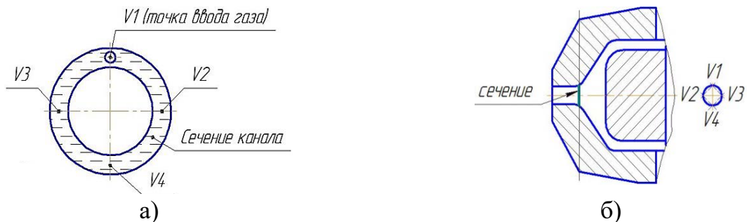
Рисунок 6 – Схема определения равномерности распределения скорости потока ПОГ: а) в расширительной камере, б) в сопловом узле плазматрона
