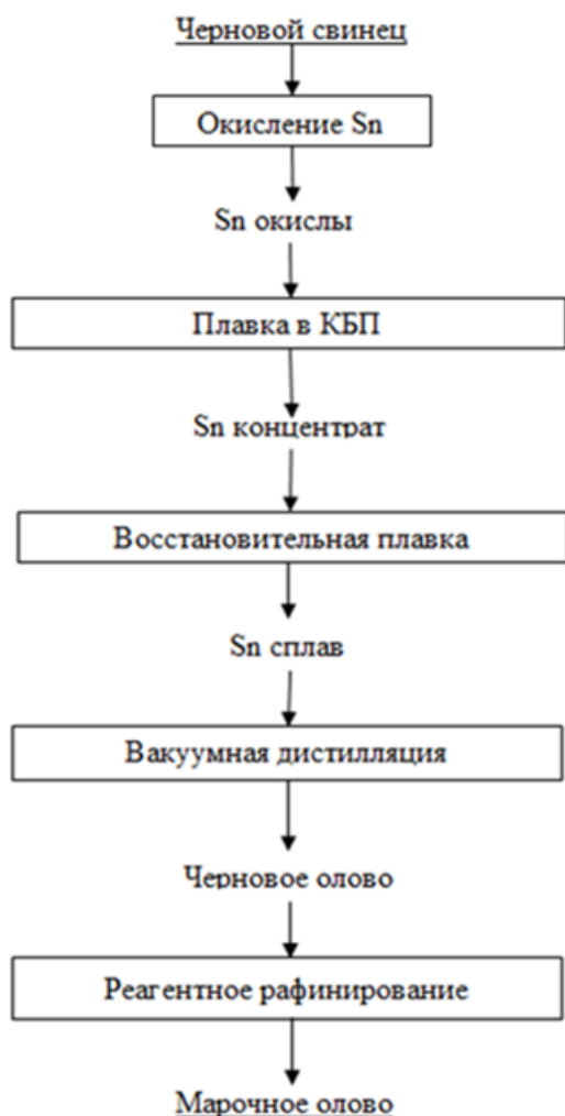
Рис. 12. Концептуальная схема производства олова и его сплавов
