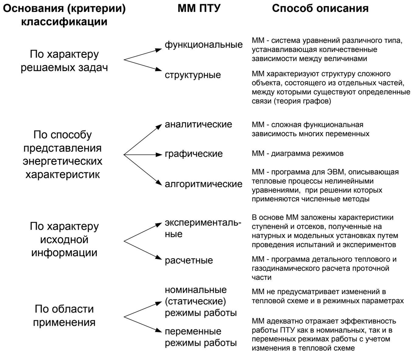
Рисунок 1 - Классификация математических моделей (ММ) паротурбинных установок (ПТУ)
