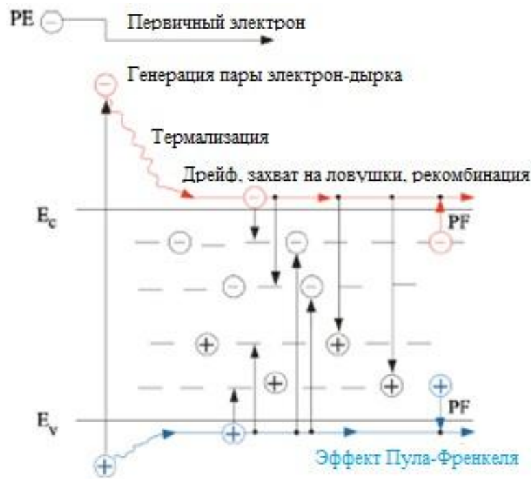
Рисунок 1.2 – Схематическое представление процессов, возникающих при облучении диэлектрика пучком электронов [4]
