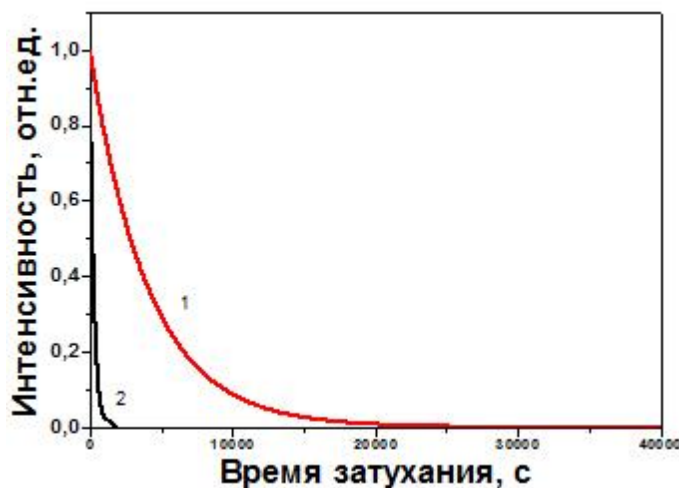
Рисунок 4.8 - Затухание рекомбинационной люминесценции с участием мелкой ловушки ( E_d = 0,8 эВ) в монокристаллическом \alpha\text{-Al}_2\text{O}_3 после возбуждения импульсом электронов с учетом (1) и без учета (2) влияния электрического поля, T = 300 К, q = 1
