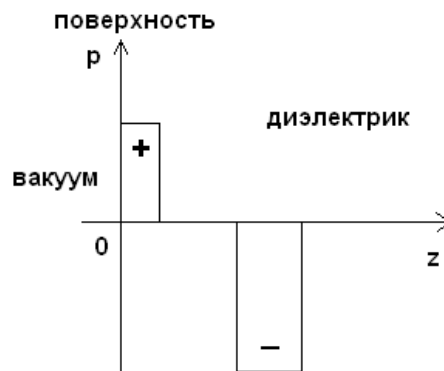
Рисунок 1.5 – «Плюс-минус» структура инжектированного заряда [11]
