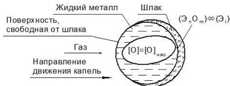
Рисунок 1.3. Схема поступления кислорода в каплю при ДМ
