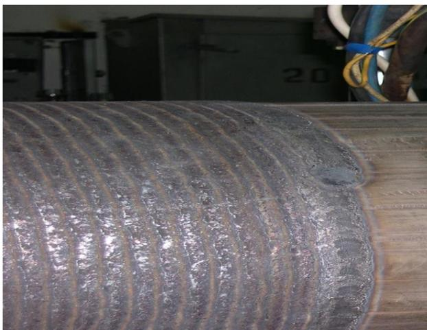
Рис. 4.11. Внешний вид изделия с наплавленным слоем стали 40X13 на токе обратной полярности.
