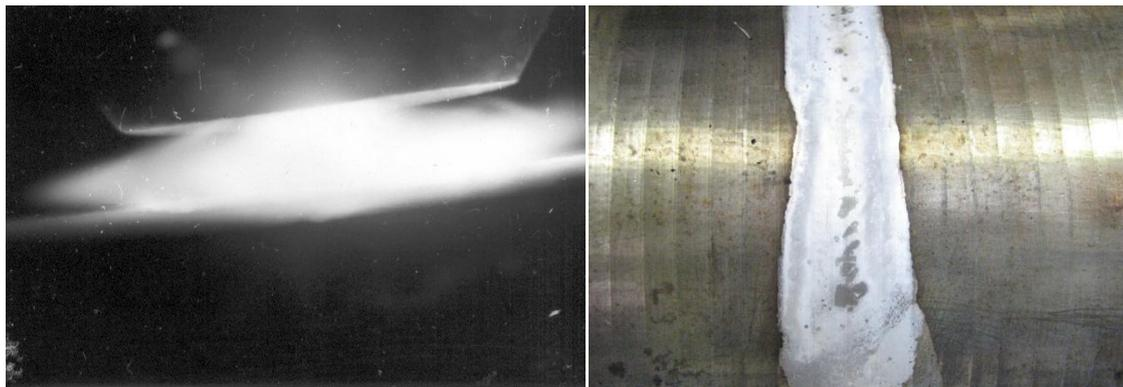
*Рис. 3.5. Процесс блуждания катодных пятен по поверхности изделия при работе плазмотрона на обратной полярности.*
