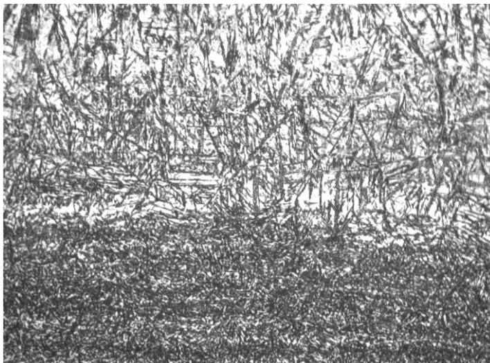
Рис. 4.16. Структура ЗТВ - Участок №4 (x400).
