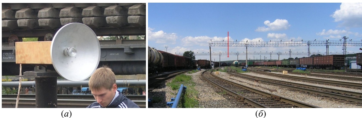
Рис. 6.8. Внешний вид (а) автодинного радиолокатора и панорама (б) парка формирования (вертикальной стрелкой указан контролируемый путь)
