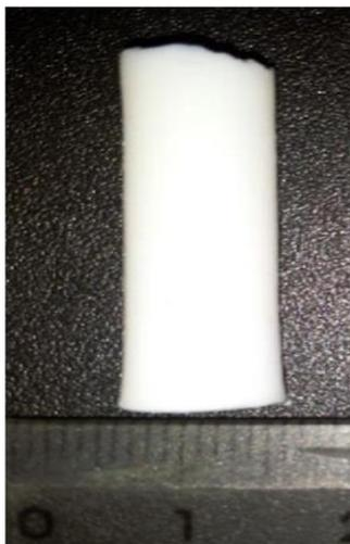
Рисунок 2.9 – Типичный вид монолитных аэрогелей на примере аэрогеля **20**
