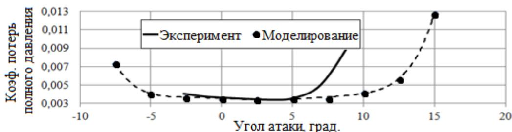
Рисунок 2.7 – Зависимость изменения потерь полного давления от угла атаки по результатам натурального и численного (SST GTM, 1500000 ячеек) экспериментов продувки решетки из профилей 10А40/15П45 при числе Маха 0,6
