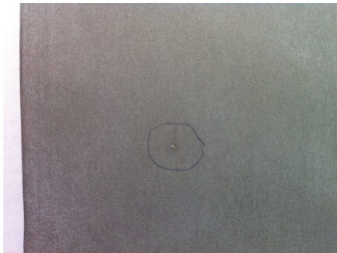
Рисунок 4.6 – Пробой анодированной поверхности.
