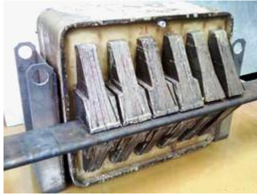
Рисунок 1.9 Индукционный МГД-насос с С-образными индукторами
