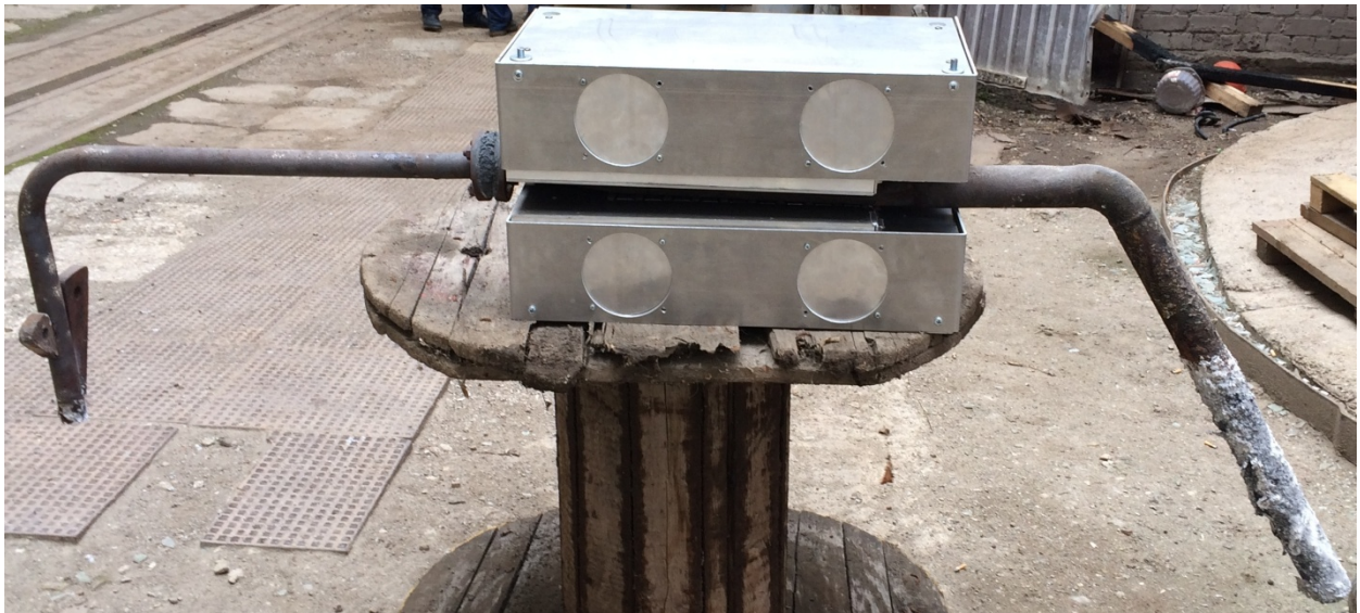
Рисунок 4.9 – Опытно-промышленный образец МГД-насоса для перекачки жидкого магния с установленным металлотрактом
