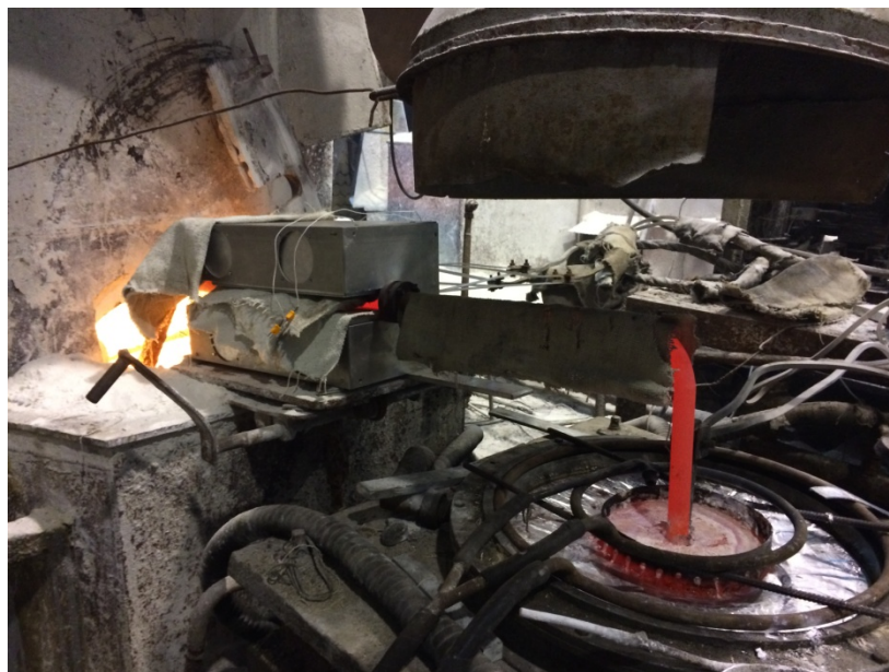
Рисунок 2.13 – Отливка магниевого сплава пи помощи опытно-промышленного образца МГД-насоса.
