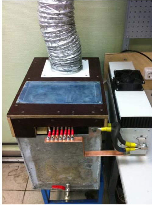
Рисунок 4.4 – Установка электролизной обработки.
