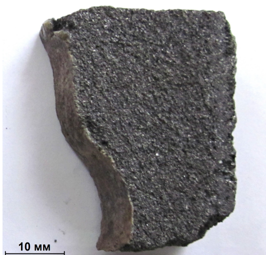
Рисунок 5.4 – Макроструктура цирконистографитового огнеупора после эксплуатации
