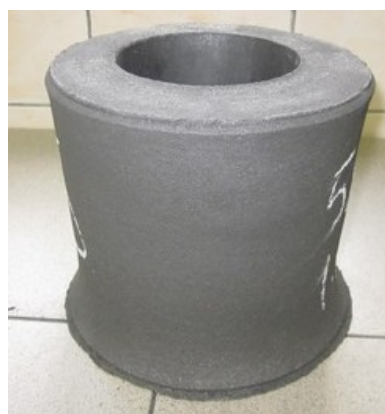
Рисунок 2.1 – Внешний вид прессованной заготовки: а – исходная заготовка; б – заготовка после обработки.
