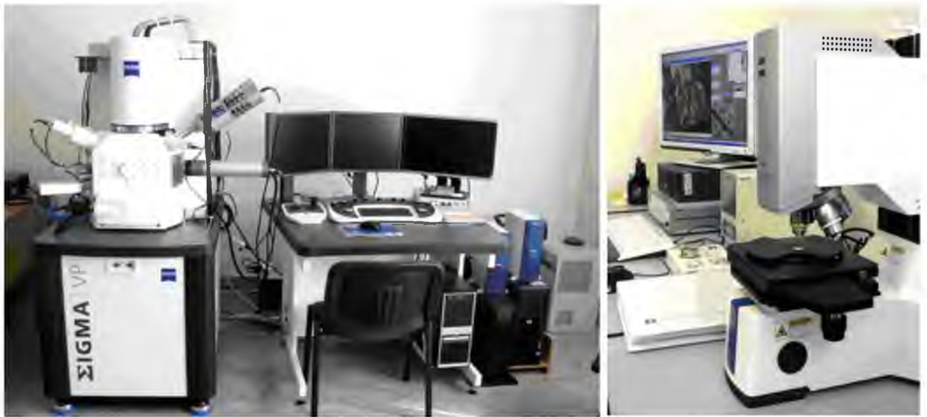
Рисунок 2.1 – Используемая аппаратура: слева - сканирующий электронный микроскоп SIGMA VP ZEISS; справа – конфокальный сканирующий оптический микроскоп Axio CSM 700 ZEISS
