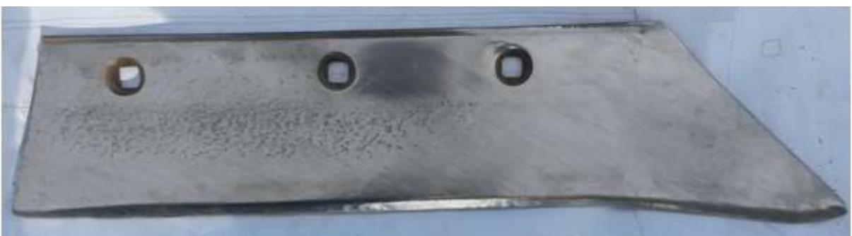
Рисунок 4.10 – Угол заточки лезвийной части лемехов по результатам эксплуатационных испытаний: a, б – внутренняя и внешняя поверхность серийного лемеха соответственно; в, г – внутренняя и внешняя поверхность опытного лемеха соответственно
