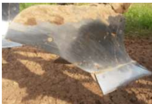
Рисунок 4.3 – Корпус: 1 – стойка; 2 – крыло отвала; 3 – болт; 4 – доска полевая; 5 – болт с шайбой и гайкой; 6 – лемех; 7 – башмак; 8 – грудь отвала
