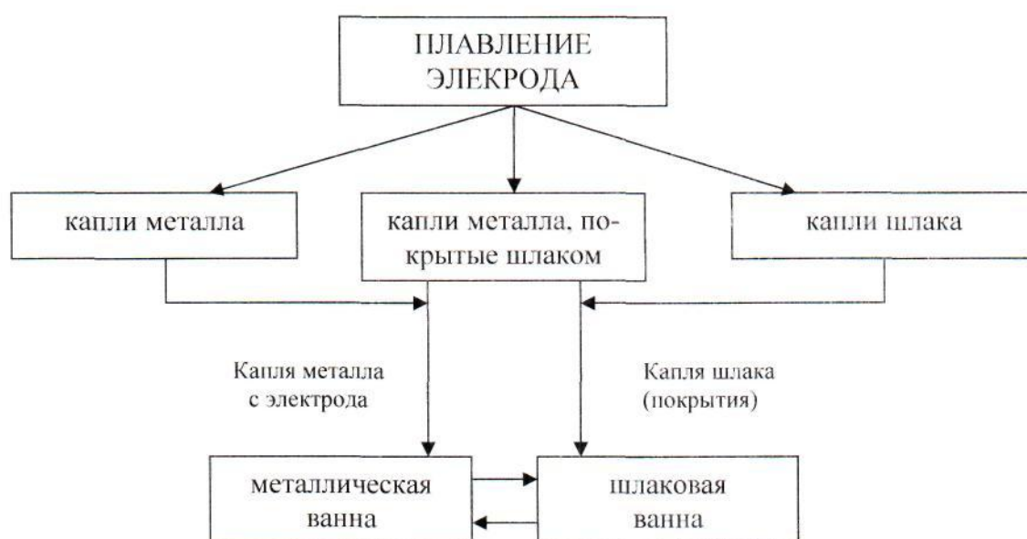
Рисунок 2.3 - Блок-схема плавления электрода
