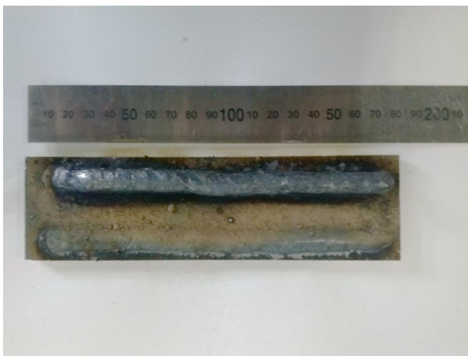
Рисунок 3.3 – Вид пластины после пятислойной наплавки
