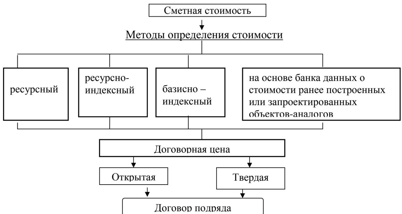
Рисунок 3- Система формирования цены в строительстве
