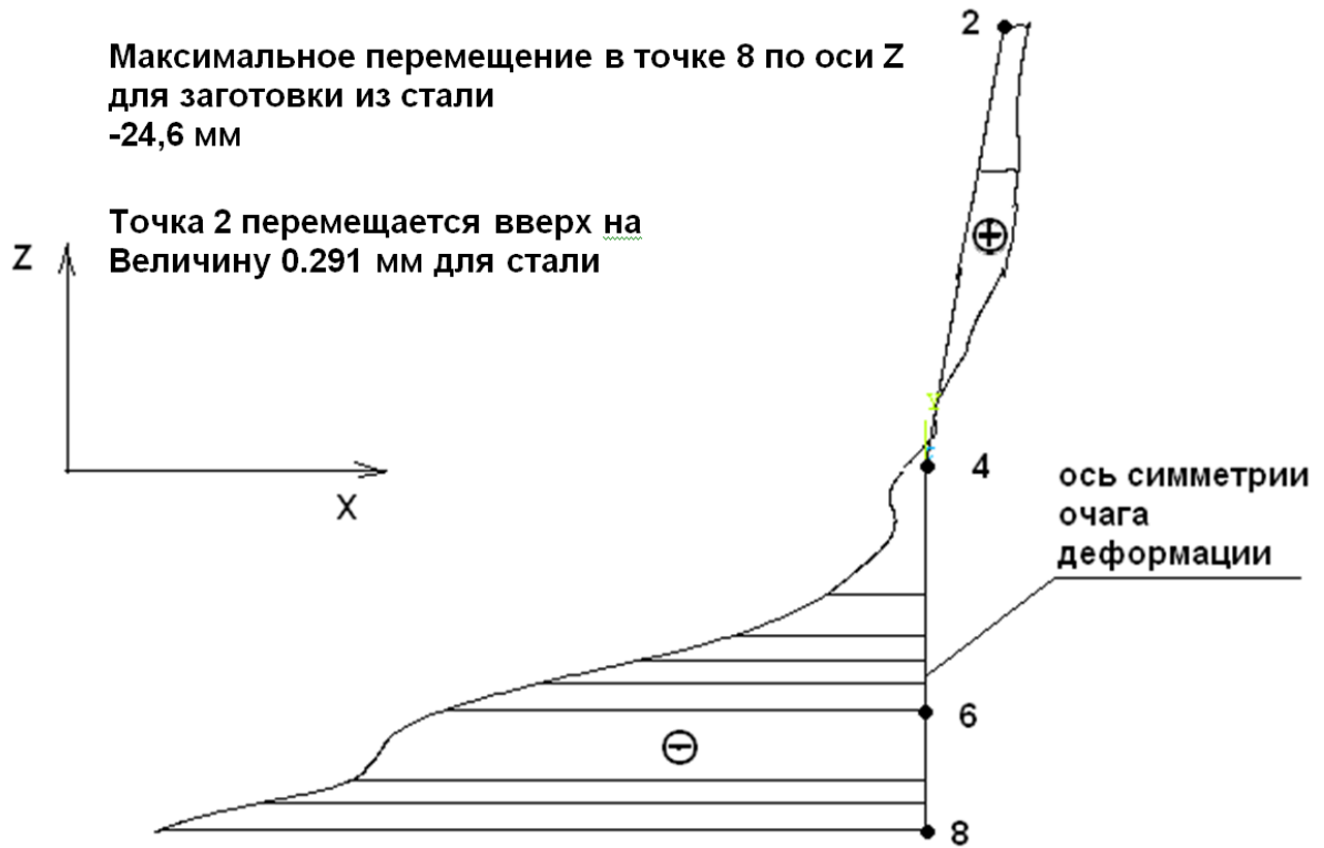
Рисунок 2.30 - Характер перемещения по оси Z вдоль линии 2-4-6-8 очага деформации
