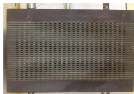
Рисунок 4.3 – Батарея твердооксидных топливных элементов планарной конструкции с несущим анодом
