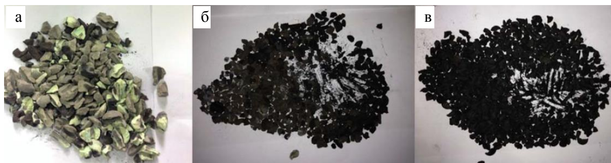
Рисунок 1.7 – Осаждение углерода вдоль трубки риформера: а – на входе, б – в середине; в – на выходе
