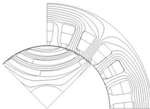
Рисунок 3.10 – Расчет двигателя в режиме \gamma = 60^\circ , I = 4 А (rms)
