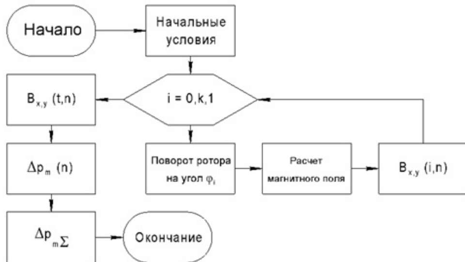
Рисунок 3.13 – Алгоритм расчета магнитных потерь в СРД
