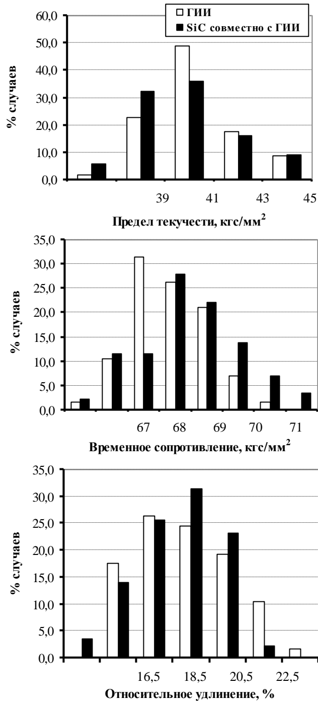
Рисунок 5.10 - Влияние технологии «базового» науглероживания высокоокисленного полупродукта на выпуске из ДСП на эксплуатационные свойства стали Д (без вакуумирования, типоразмер трубы 245×7,9 мм×мм; число плавов с науглероживанием только ГИИ – 57, с совместным науглероживанием SiC и ГИИ – 86)
