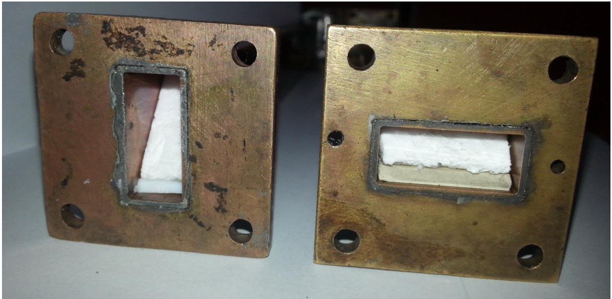
Рисунок 3.17 – Практическая реализация частично заполненных волноводов
