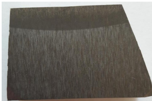
Рисунок 5.1. – Макроструктура поперечного сечения втулки насоса из стали X12MФЛ после закалки рабочей поверхности с помощью ТВЧ X 3
