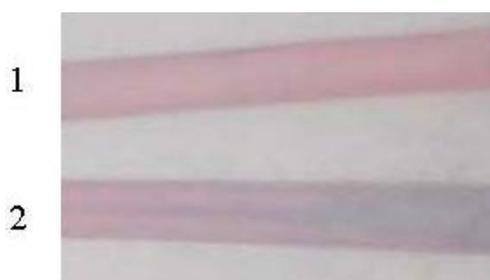
Рисунок 5.8 – Полоски мембранного фильтра, пропитанные золем золота, (1) после контакта с водой и (2) водным раствором глутатиона ( $1 \cdot 10^{-3}$  моль/дм<sup>3</sup>)
